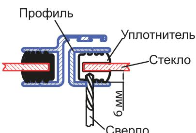
Сверловка бокового профиля для крепления упорных стоек.
