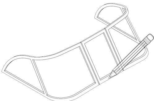
Для дальнейшего, точного, позиционирования ветрового стекла относительно оси симметрии лодки. Так же необходимо отметить центр палубы в районе выхода (калитки).
