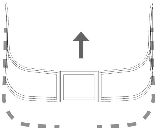
7.1 Откручиваем рамку от палубы лодки и снимаем её.
