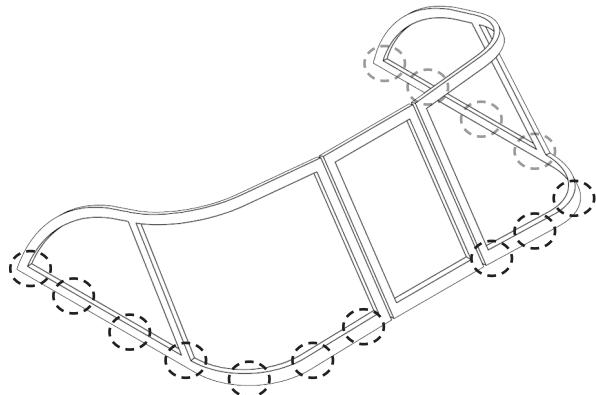
Затем в отмеченных ранее точках, с помощью сверла 4,8 мм в палубе лодки просверливаем отверстия и фиксируем рамку к корпусу лодки винтами M4x40
